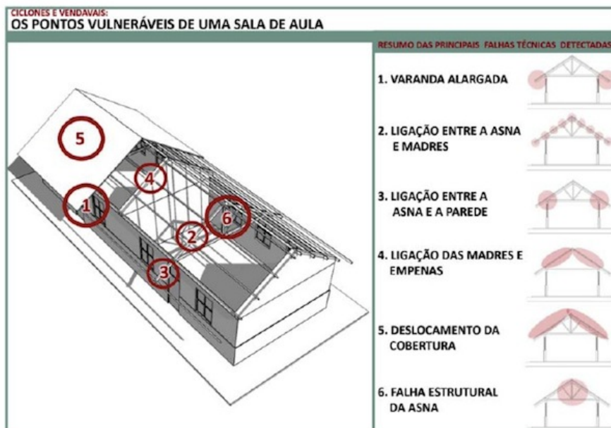
Figura 19 - Os pontos mais vulneráveis de uma sala de aula de material convencional perante ciclones e ventos fortes
